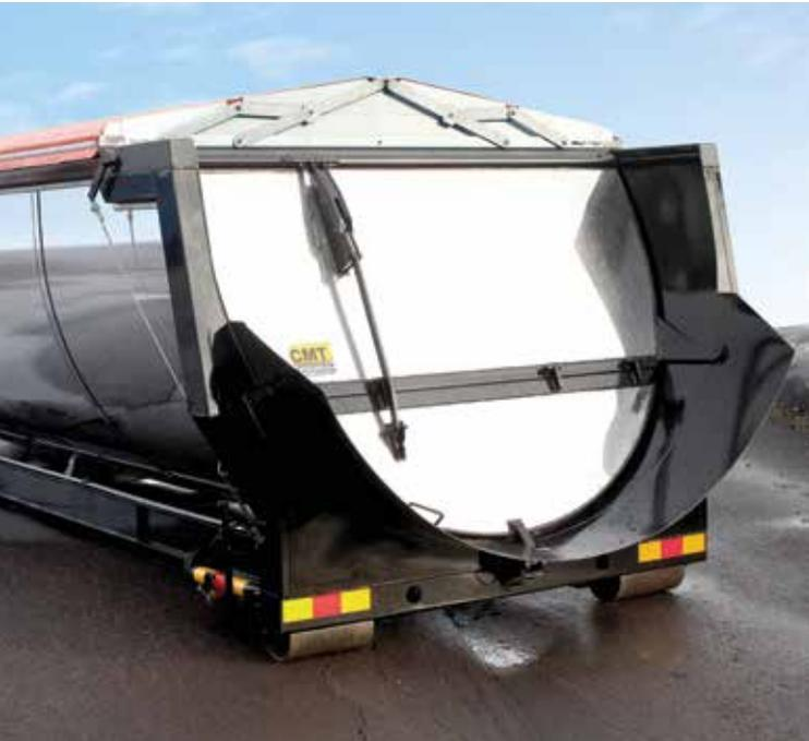
**Dank hoher Qualität von Konstruktion und verwendetem Stahl sind hohe Nutzlast und lange Lebensdauer garantiert. Der Behälter ist ausserdem durch eine Luftspalte rundum wärmeisoliert, sodass der Asphalt mit der richtigen Temperatur geliefert wird.**
